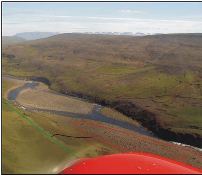
Mynd 2. Ljósmynd af námu A-0. Mögulegt efnistökusvæði er afmarkað með rauðri línu (Ljósmynd Gunnar H. Jóhannesson, ágúst 2006).
